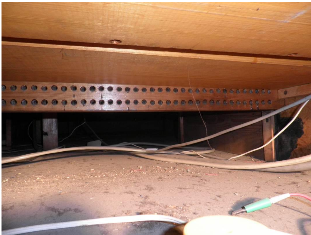
57. Abbildung: Erhaltene Führungselement der pneumatische Traktur unter den Spieltisch
