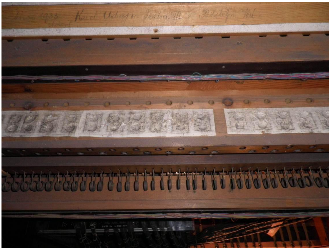
51. Abbildung: Erhaltene Rahmenmembranenkoppel. Auf den Deckel Inschrift Urbans mit den Fertigstellungsdatum des Spieltisches: August 1933
