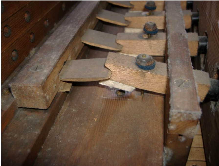
50. Abbildung: Auslassventile der Kippschalter in Prag St. Benedikt
