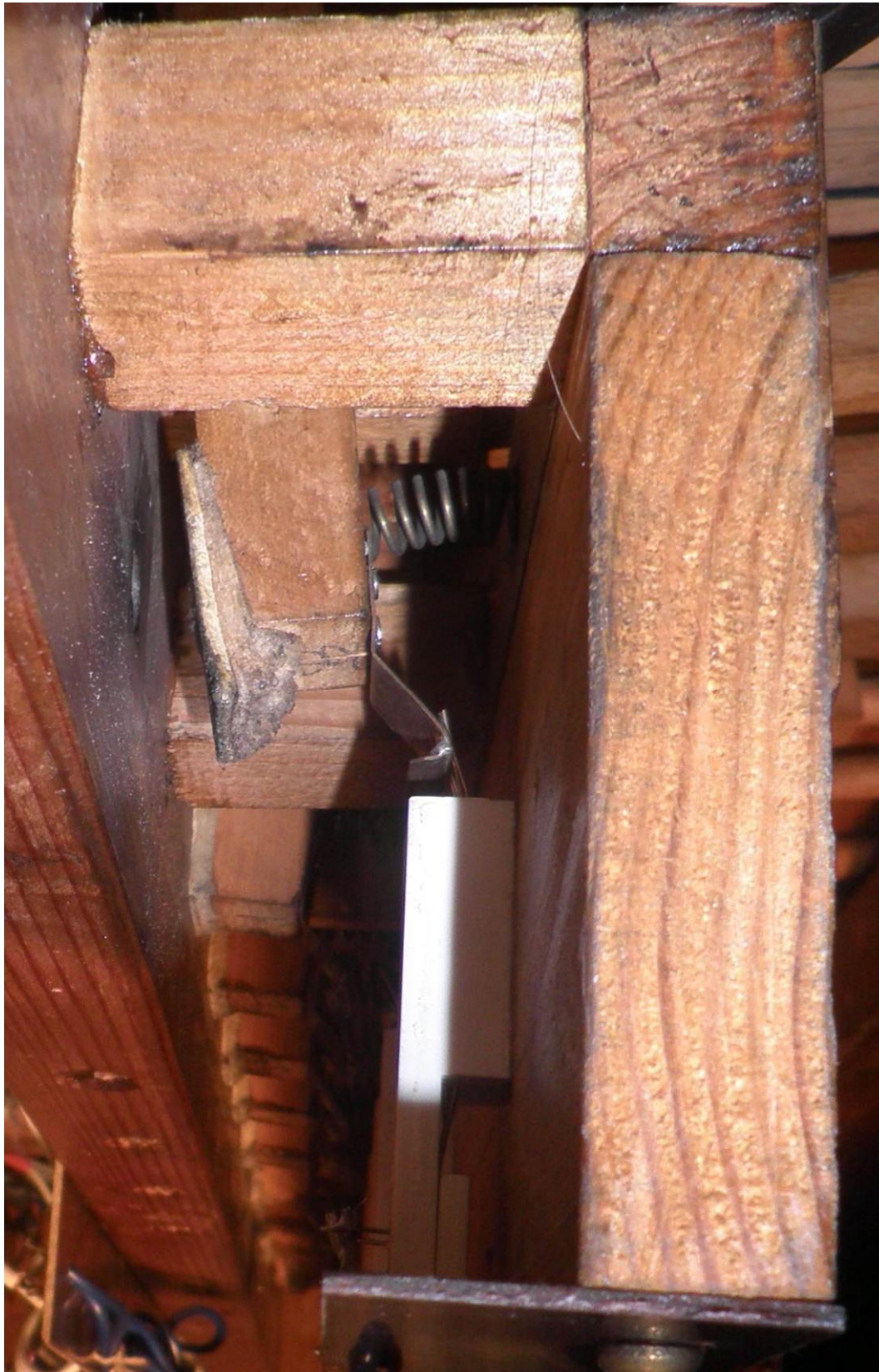
53. Abbildung: Auslassventile der Feste Kombinationen, mit elektrischen Kontakte versehen
