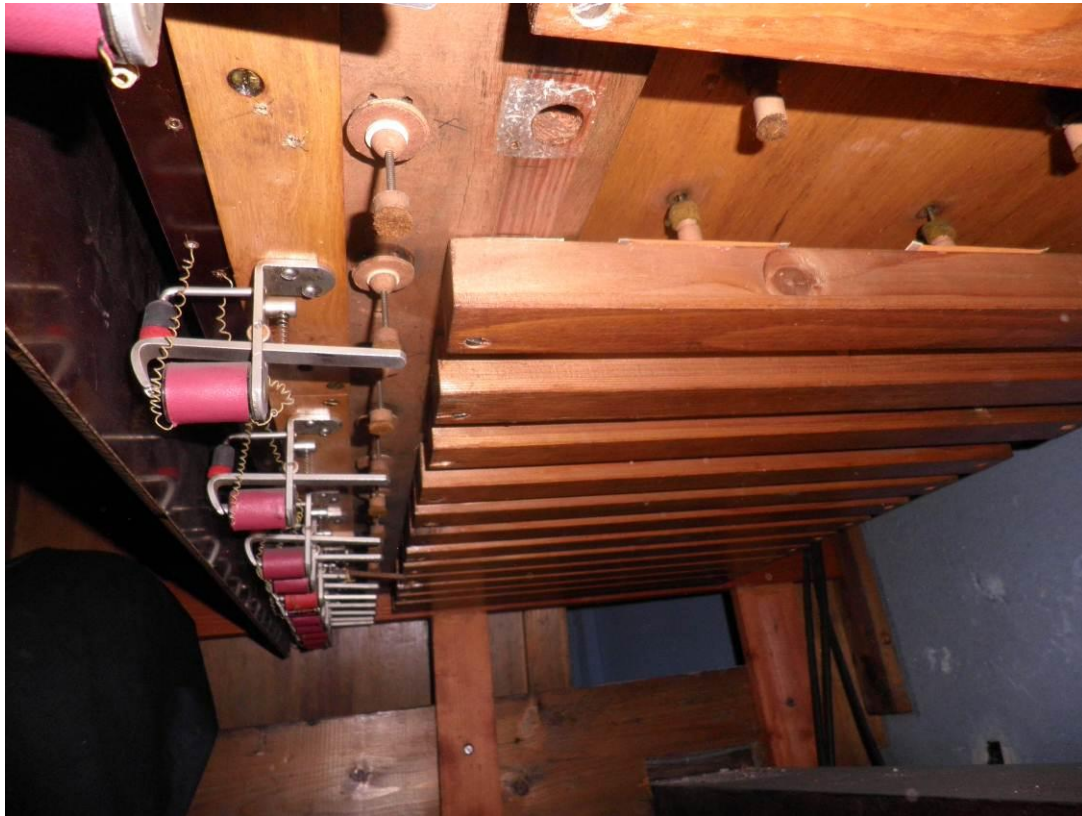
29. Abbildung: Mit Magnete unterlegte Pedallade, mit fehlenden Membranenleisten der Superoktavtöne.
