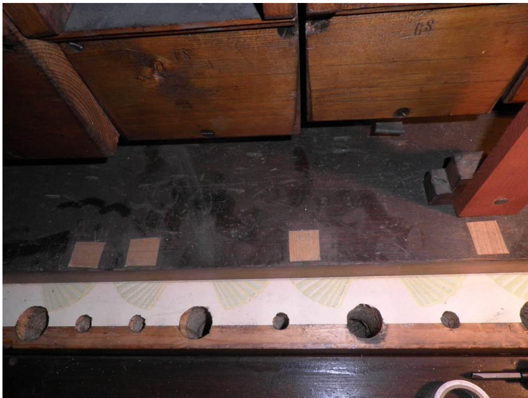
32. Abbildung: Abgeschraubte Stock, zugemachte Bohrungen der Superoktavtöne, C Seite
