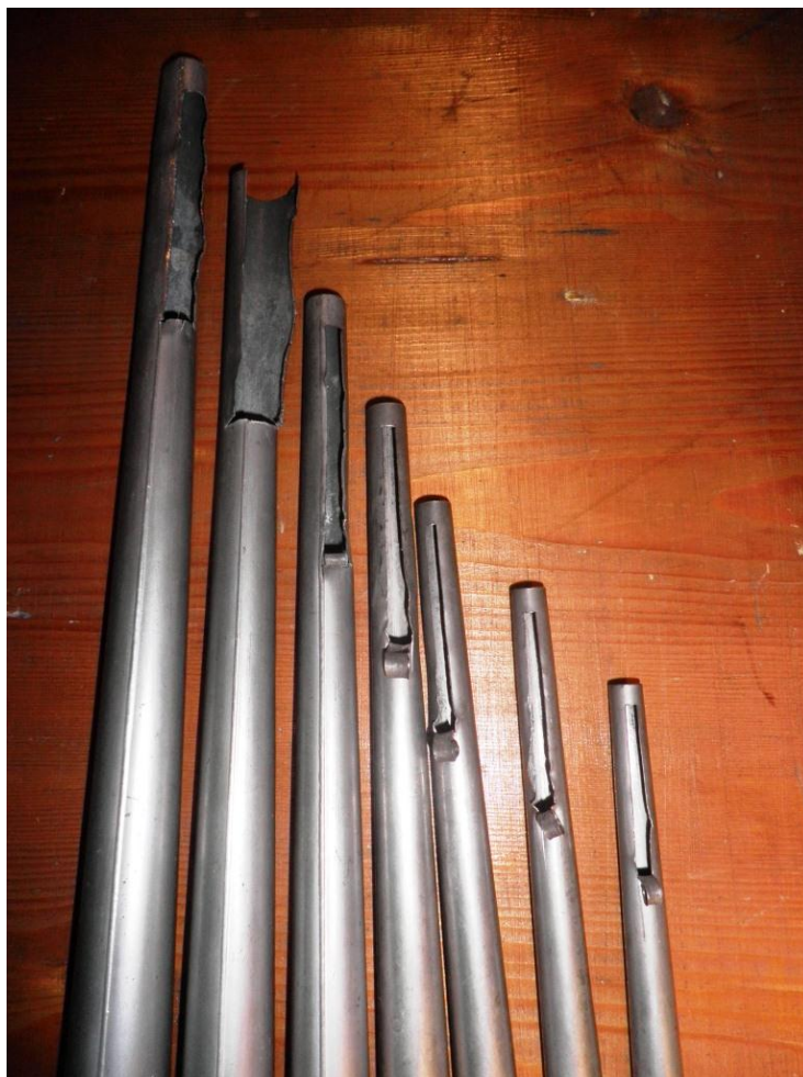
95-96. Abbildungen: Kvinta aus den ehemaligen Gemshorn 4& Zerrissene Pfeifenkörper
