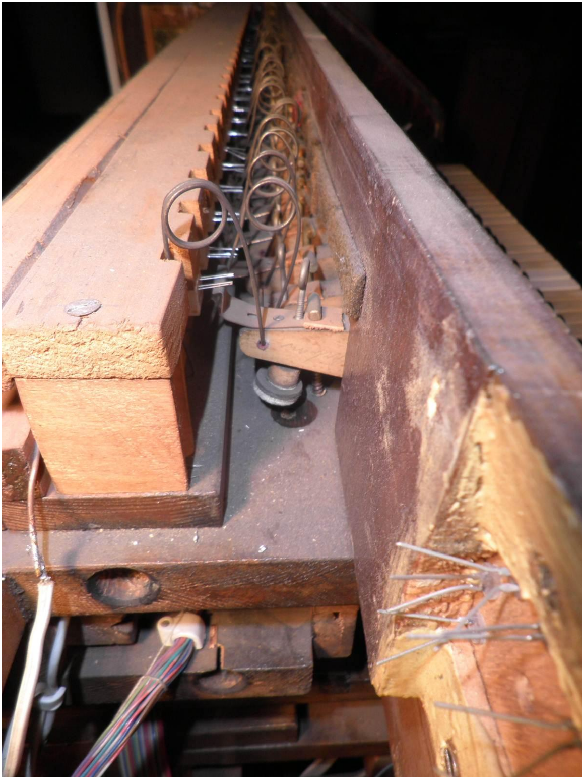
49. Abbildung: Auslassventile der Registerwippen, 1983 mit elektrische Kontakte versehen
