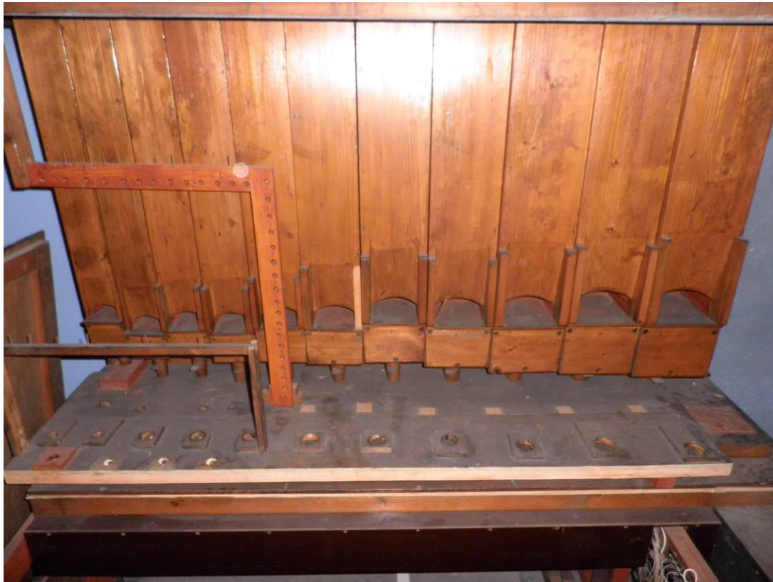
31. Abbildung: Pedallade C Seite, zugemachte Bohrungen der Superoktavtöne, Raster gebaut aus den Teile der Pneumatische Traktur
