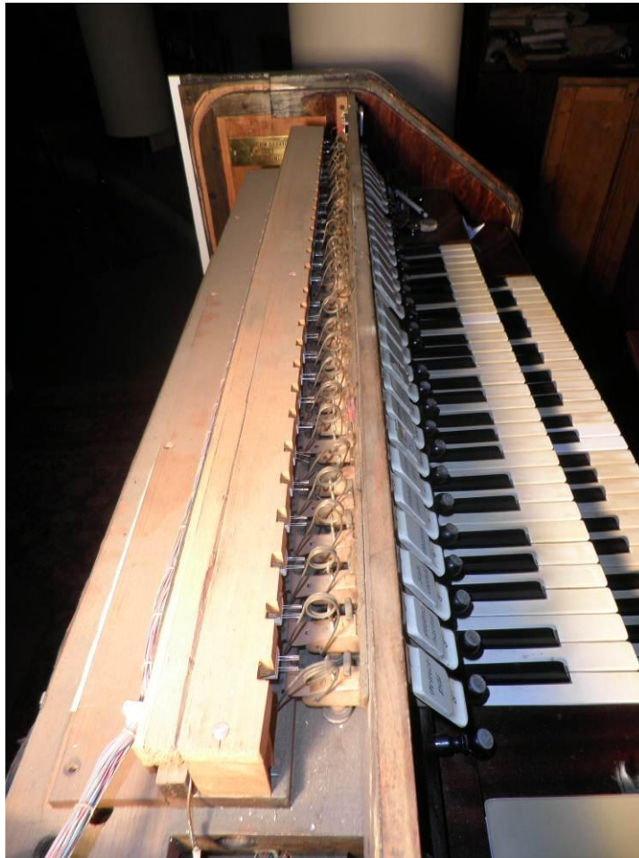
47. Abbildung: Wippschalter aus 1955
