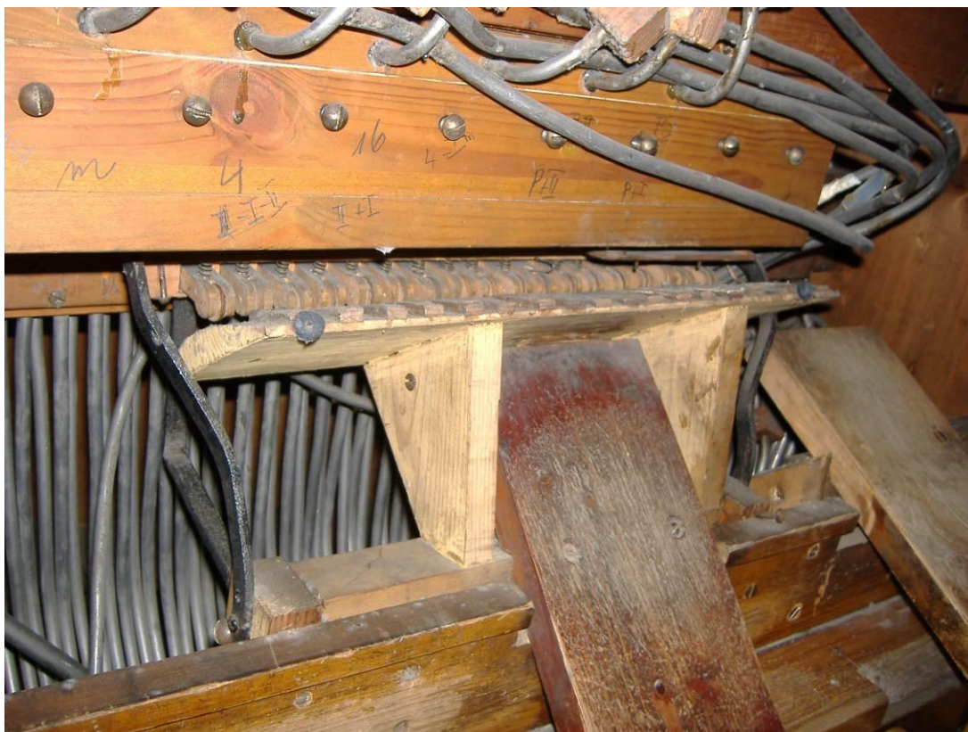
62. Abbildung: Crescendoapparat in Prag St. Benedikt, nach Beschreibung von Augenzeugen war in der Koranda-Orgel die gleiche Konstruktion
