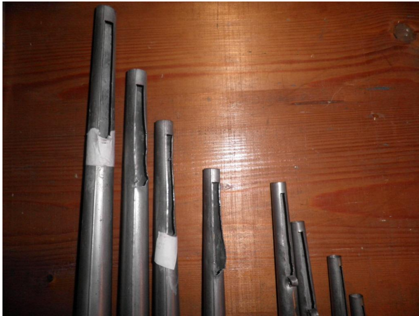
95-96. Abbildungen: Kvinta aus den ehemaligen Gemshorn 4& Zerrissene Pfeifenkörper
