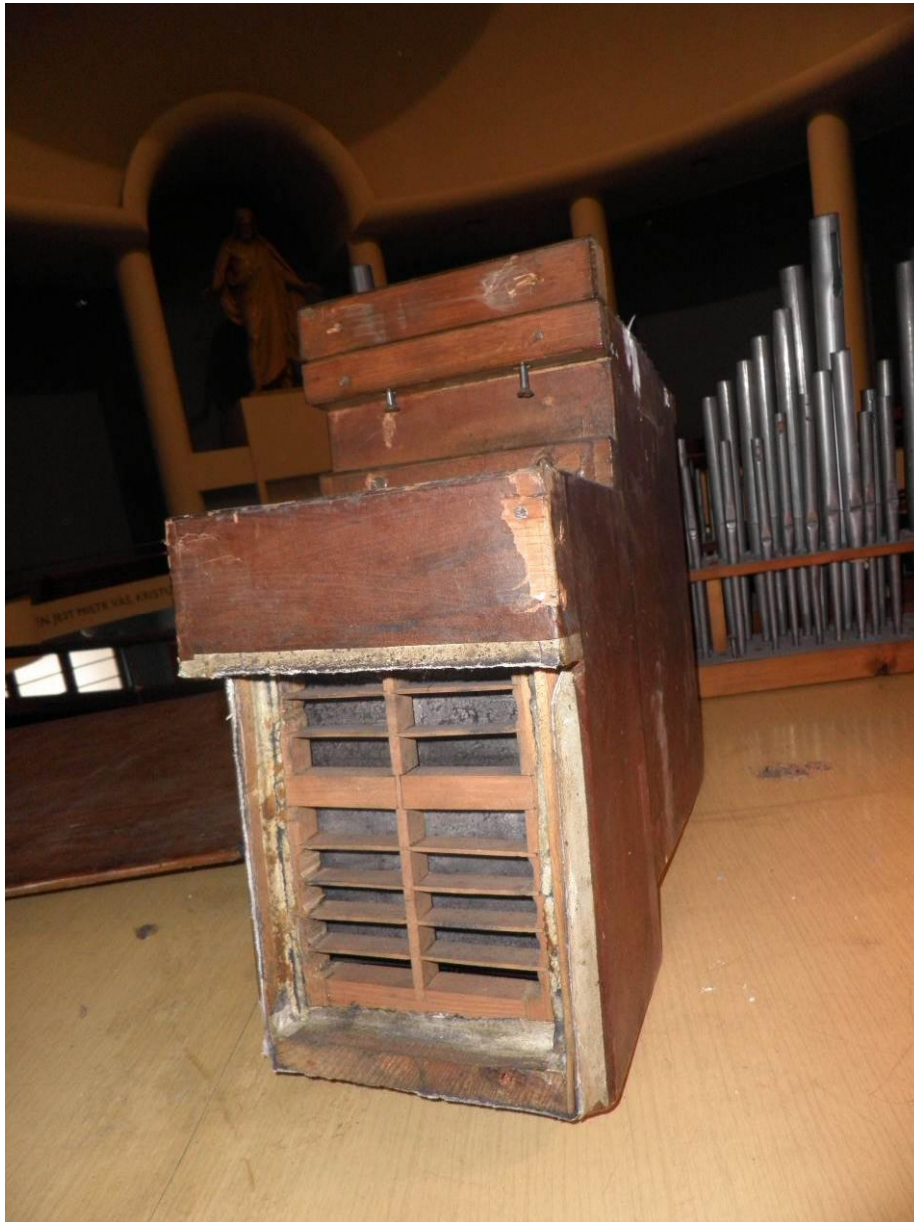
20. Abbildung: Das alte Drosselventil
