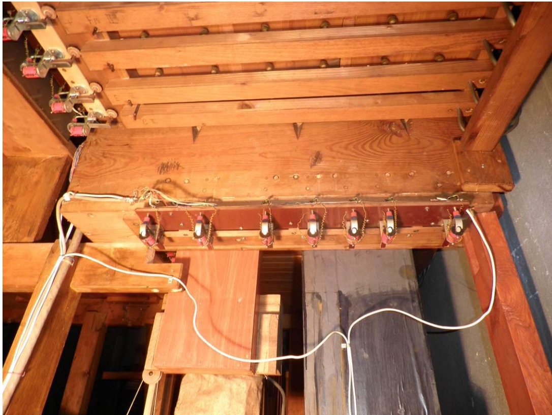
27. Abbildung: Registerschaltapparat des II. Man mit unterlegten Magneten
