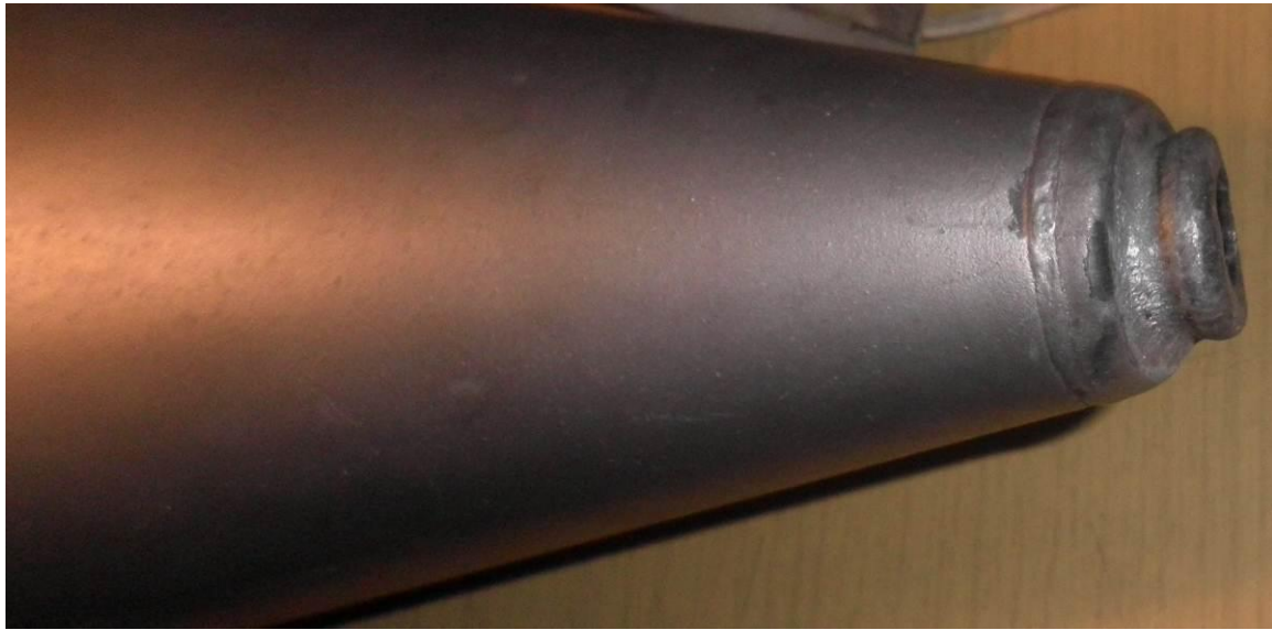
67. Abbildung: Beschädigtes Zinn Fußspitze einer Prospektpipe
