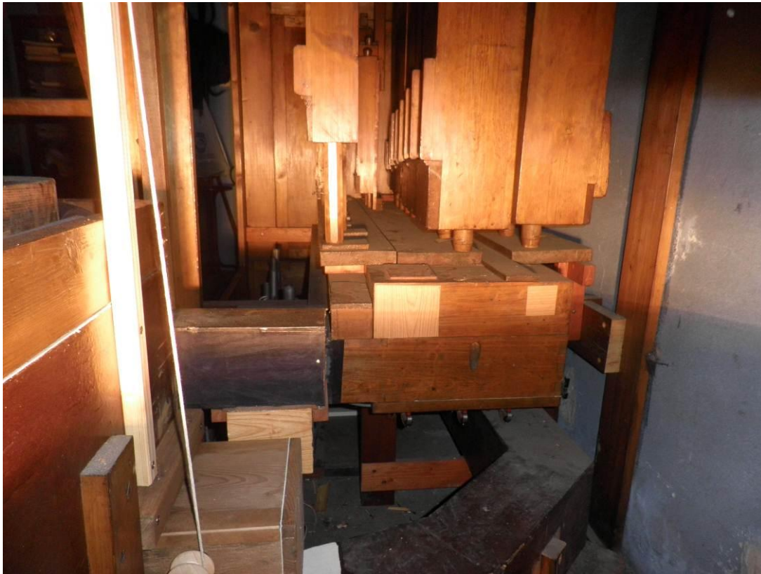
25. Abbildung: Die zweigeteilte Pedallade mit durch Urban zugemachten Registerkanzellen
