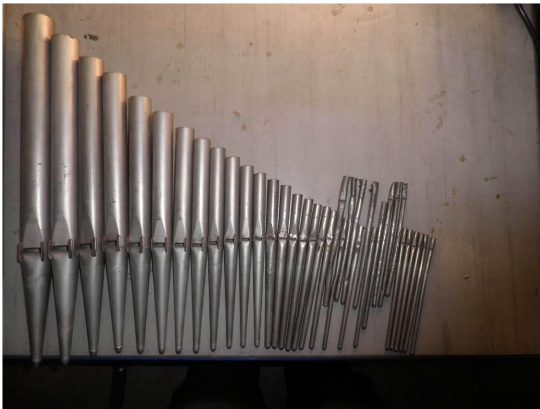
82. Abbildung: Abgeschnittene Pfeifen Gamba 8ö
