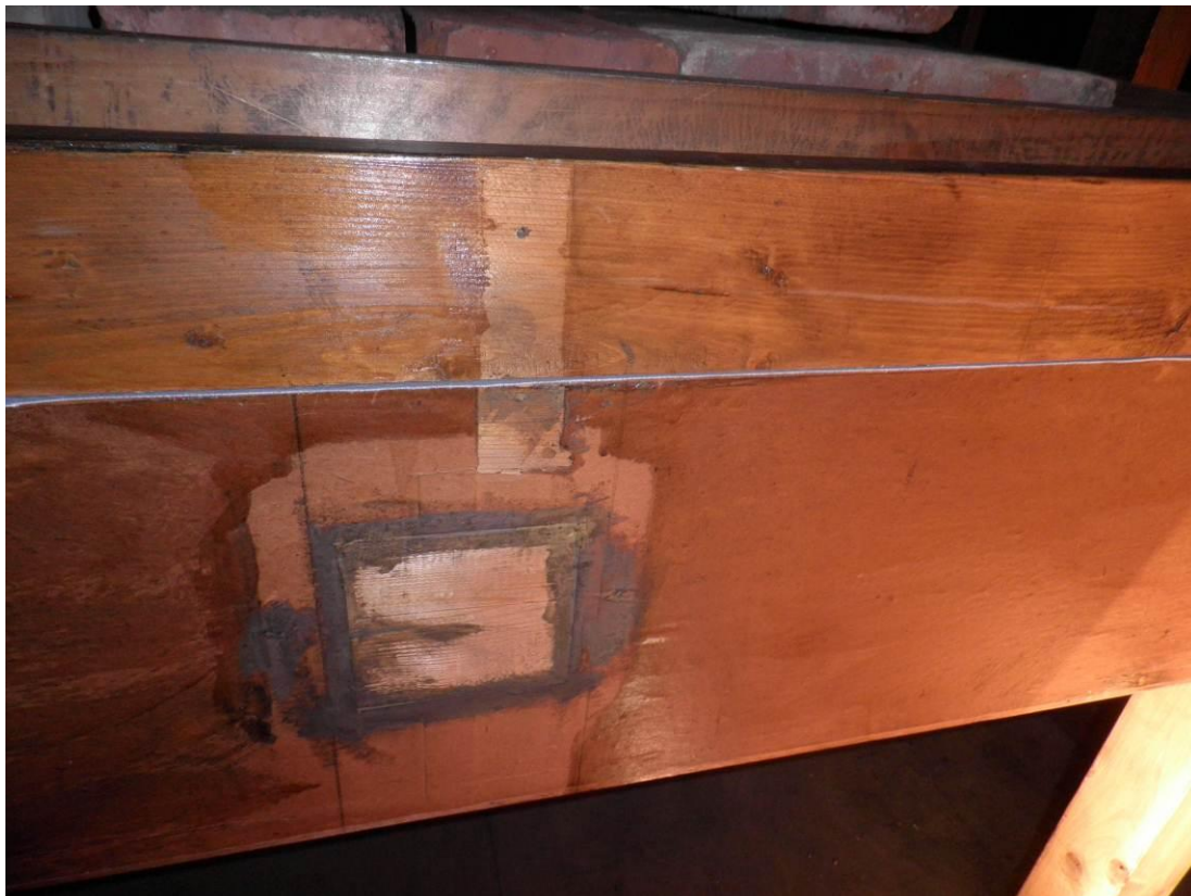
17. Abbildung: Zugemachte Öffnung am Magazinbalg
