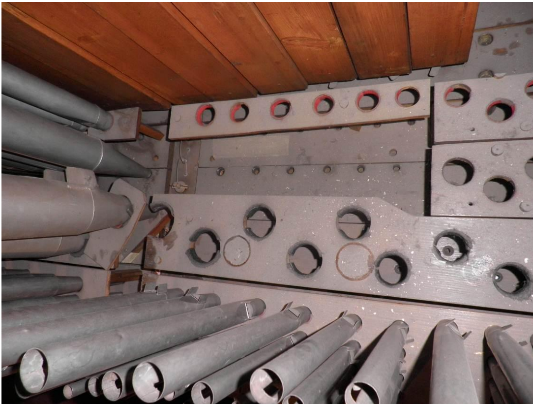
35. Abbildung: Mit Filz eingewegte Rasterlöcher im HW C# Seite
